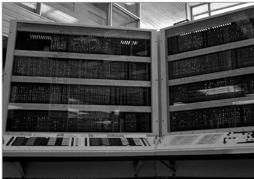
«Линейки» электронных блоков БЭСМ-6
