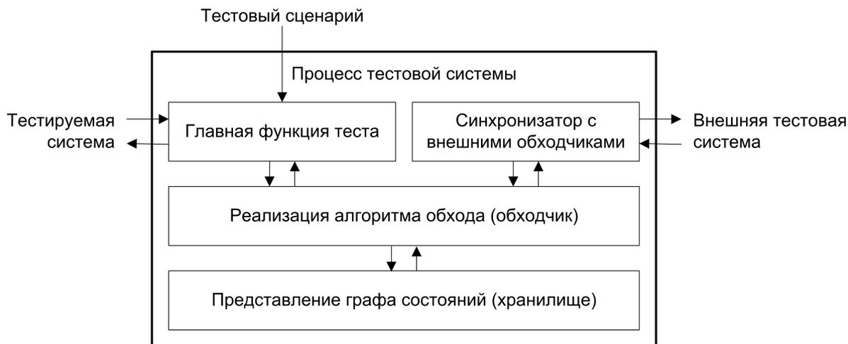
Рис. 1. Устройство процесса тестовой системы
